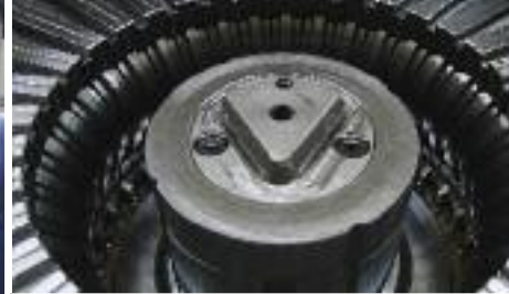
Für das Werkzeug mit verstellbaren Rollen zur Herstellung von Lamellentragern bekam WEBO das erste Patent.
